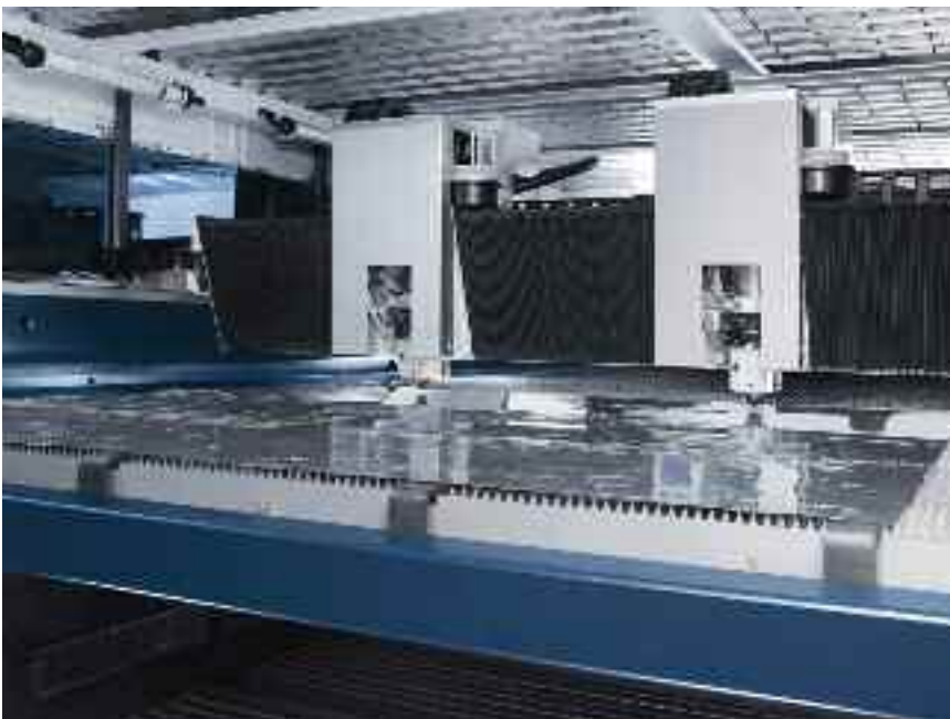
Bild 6: Mit dieser Laserschneidmaschine können zwei Teile gleichzeitig bearbeitet werden – besonders für die Produktion großer Stückzahlen dünner Bleche eine vorteilhafte Lösung. Für das Schneiden dickerer Bleche lässt sich die Laserleistung auch auf einen Schneidkopf konzentrieren
