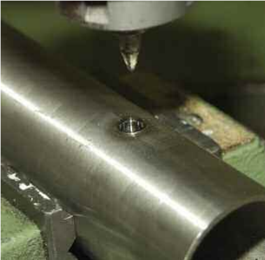
Bild 9: Das Fließbohren ist ein geeignetes Verfahren, wenn die Materialstärke nicht ausreicht, um genügend Gewindegänge einzubringen
