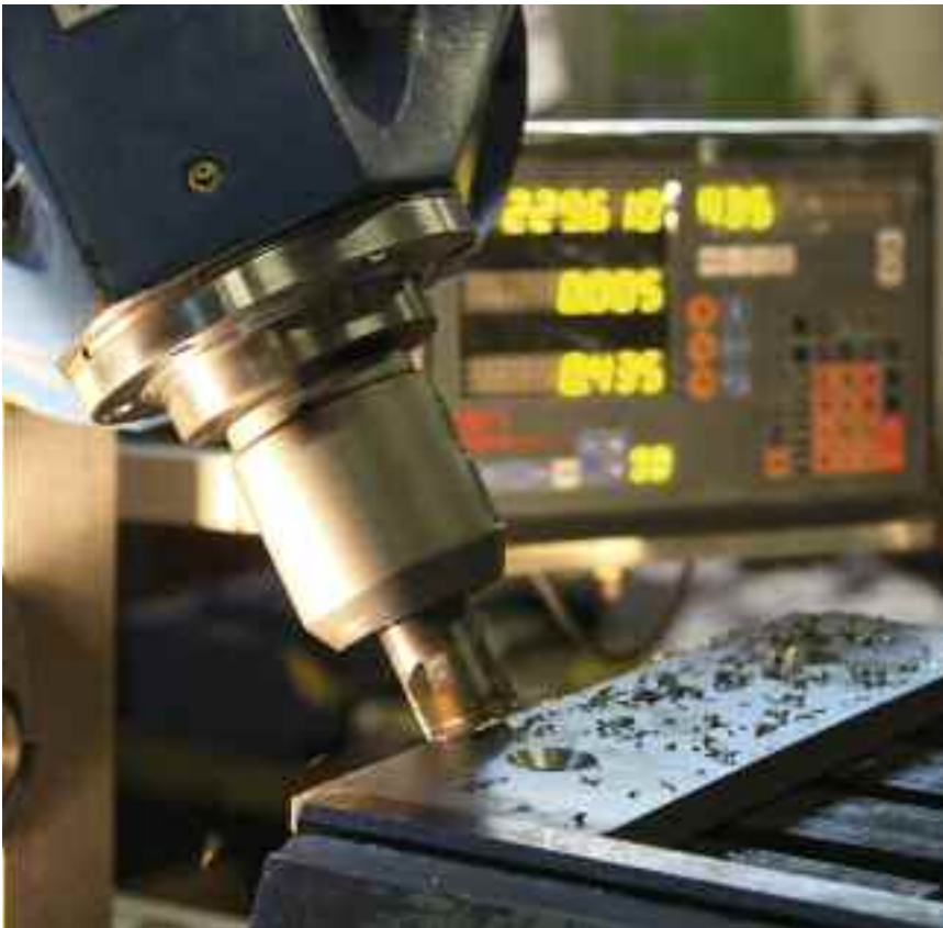
Bild 11: Bei der spanenden Bearbeitung, wie hier beim Fräsen einer Fase, muss nach jedem Schnitt die kaltverfestigte Schicht aus dem vorigen Durchgang vollständig abgehoben werden
