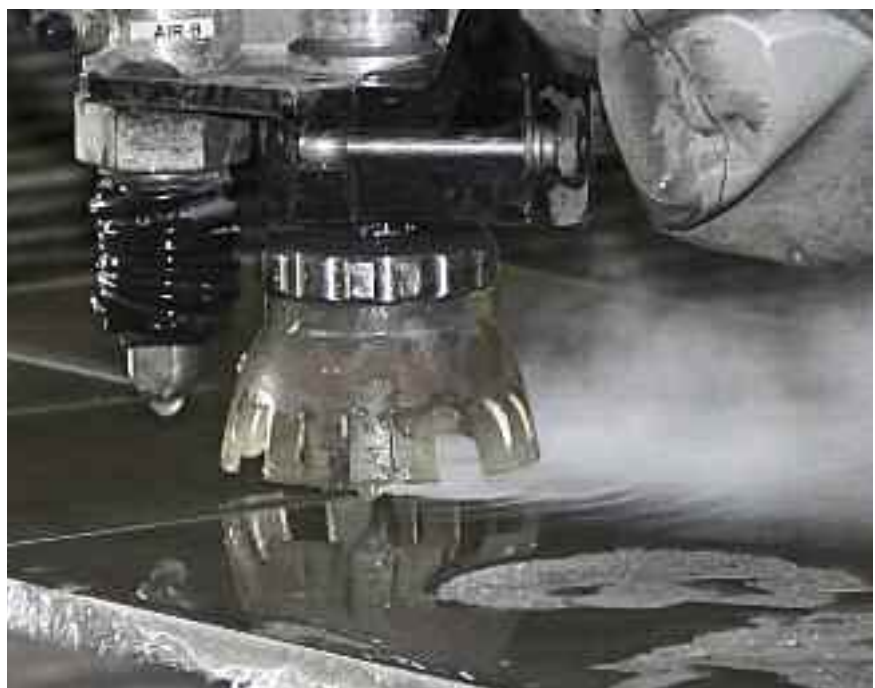
Bild 4: Mit modernen Wasserstrahlschneidanlagen sind sogar dreidimensionales Schneiden und Schrägschnitte möglich
