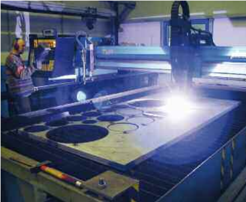
Bild 5: Das Plasmaschneiden eignet sich besonders für dicke Bleche: Im Unterschnitt sind bis zu 50 mm, im Trockenschnitt bis zu 110 mm möglich
