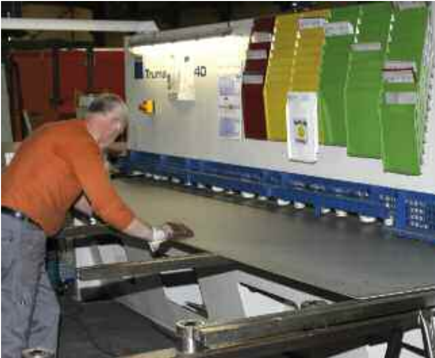
Bild 2: Beim Schneiden von Edelstahlblechen benötigt man mehr Kraft als für unlegierte Stähle. Da aufgrund der höheren Festigkeit Bleche aus nichtrostendem Stahl aber in der Regel dünner sind, nähern sich die Scherkräfte an
