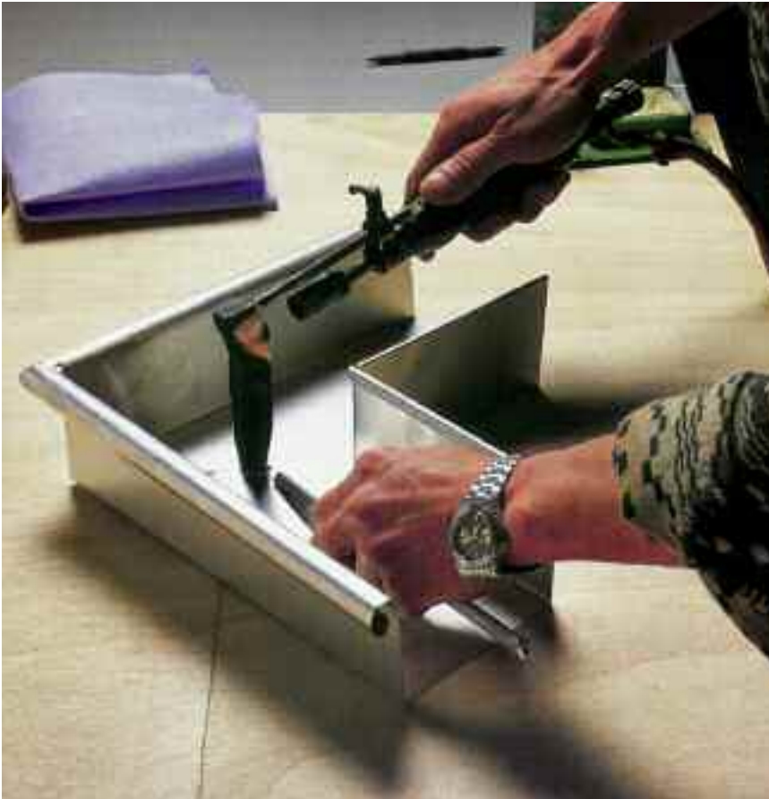
Bild 19: Edelstahl Rostfrei ist auch unter handwerklichen Praxisbedingungen problemlos und ergebnissicher lötlbar
