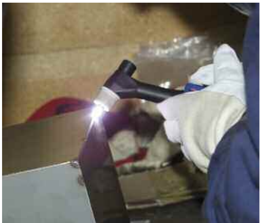
Bild 18: Ein alternatives Schweißverfahren ist das Plasmahandschweißen mit und ohne Schweißzusatzwerkstoff
