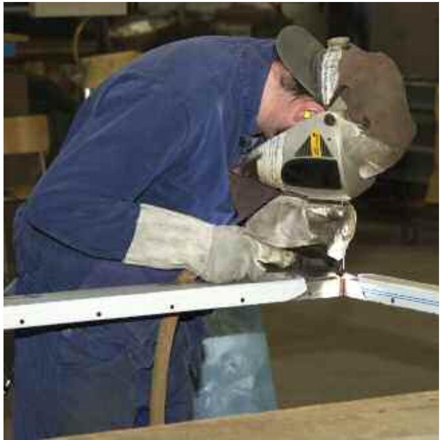
Bild 17: Im Apparate- und Behälterbau ist eine sorgfältige Schweißnahtausführung von besonderer Bedeutung. Das WIG-Schweißen kann von Hand oder mit automatischen Einrichtungen erfolgen
