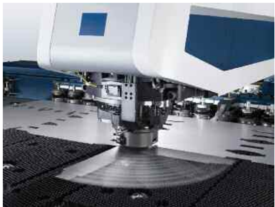
Bild 3: Moderne Stanzenmaschinen lassen heute kein Restgitter mehr übrig – das erhöht die Materialausnutzung und die Prozesssicherheit
