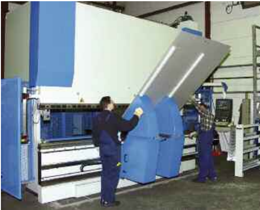
Bild 12: Bei der spanlosen Bearbeitung, wie hier beim Abkanten, tritt bei nichtrostenden Stählen durch die Kaltverformung in der Regel eine Kaltverfestigung auf
